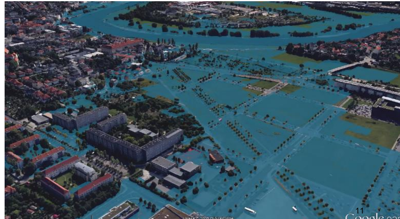
Dresden: 100-jährliches Hochwasser OHNE Hochwasserschutz
